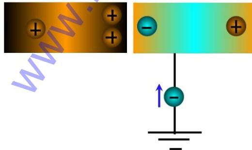
Para que se produzca un equilibrio entre los extremos cercanos y polarizados, suben electrones de tierra hacia el cuerpo neutro a través de la conexión a tierra.
