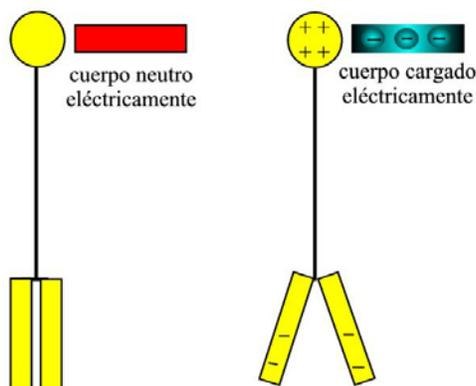
*Observación:* Si el electroscopio tiene una escala de medición entonces se llama **electrómetro** y serviría, además, para medir la cantidad de carga que tiene un cuerpo.
